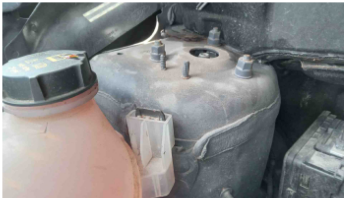
Foto Estrutura Torre do Amortecedor Direito
