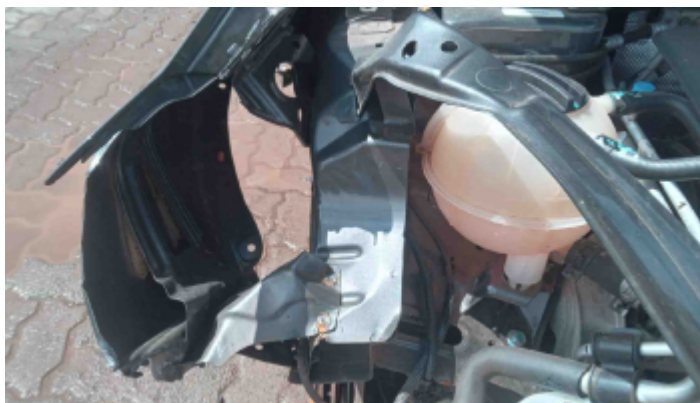
Foto Avaria Painel Dianteiro
