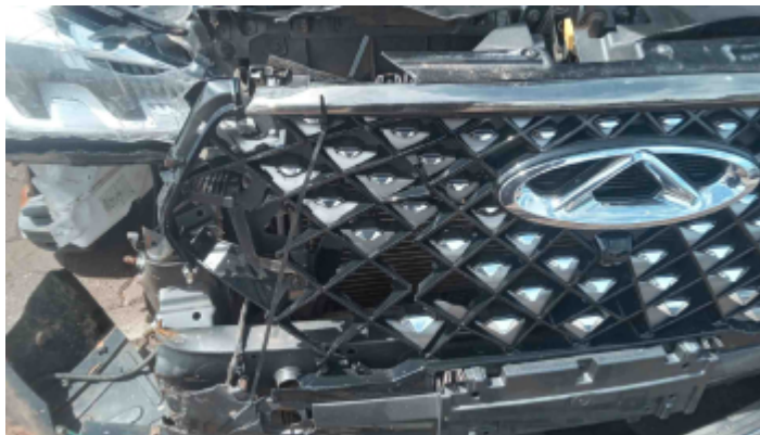
Foto Avaria Grade
