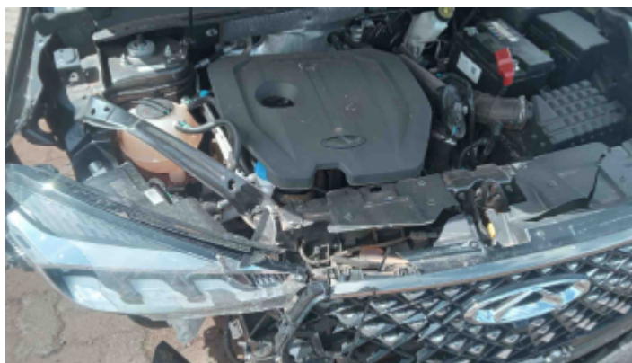
Foto Avaria Painel/Saia Dianteiro
