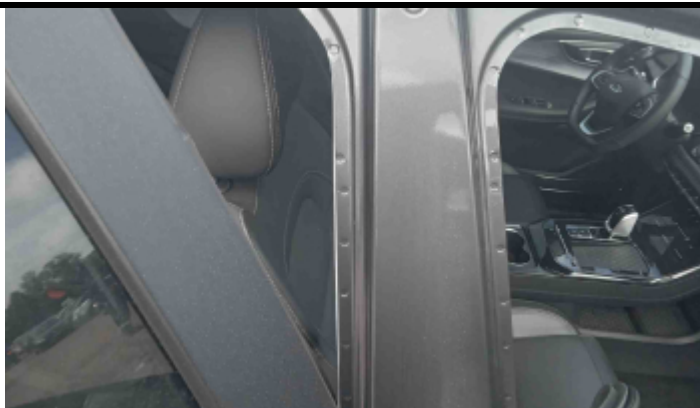
Foto Estrutura Coluna Central Direita
