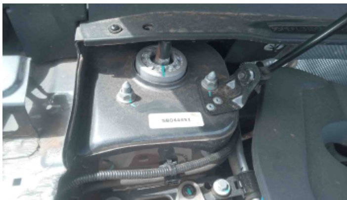
Foto Estrutura Torre do Amortecedor Direito
