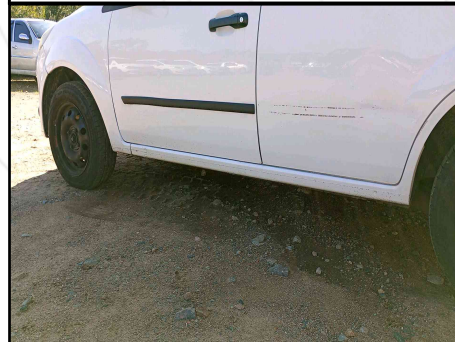
CAIXA DE AR/ SOLEIRA ESQUERDA
