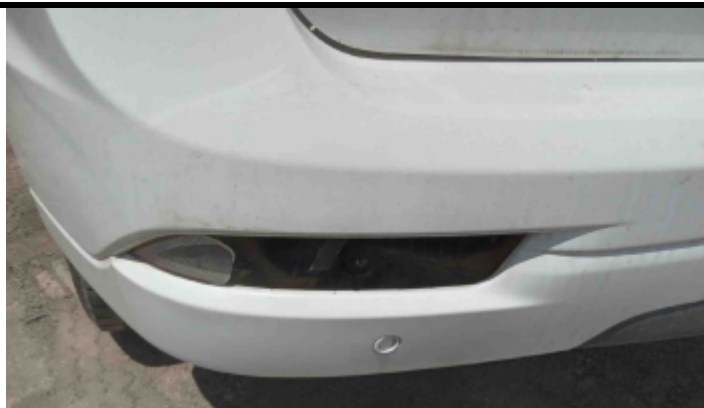
Foto Avaria Pára-Choque Traseiro
