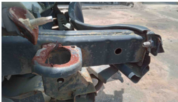
Foto Estrutura Longarina Direita
