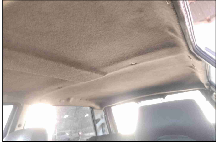
REVESTIMENTO DO TETO
