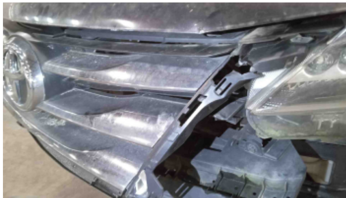
Foto Avaria Grade
