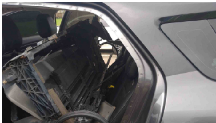
Foto Estrutura Coluna Traseira Esquerda
