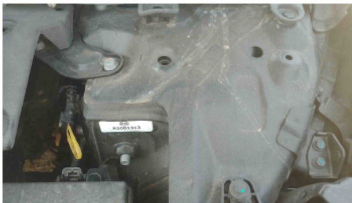
Foto Estrutura Torre do Amortecedor Esquerdo
