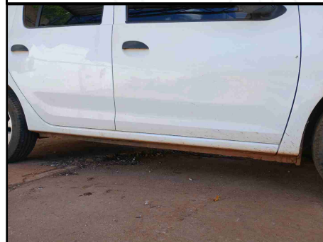
CAIXAS DE AR - SOLEIRA DIREITA
