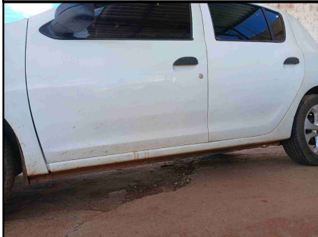
CAIXAS DE AR - SOLEIRA ESQUERDA
