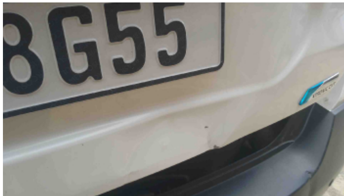
Foto Avaria Tampa do Porta Malas
