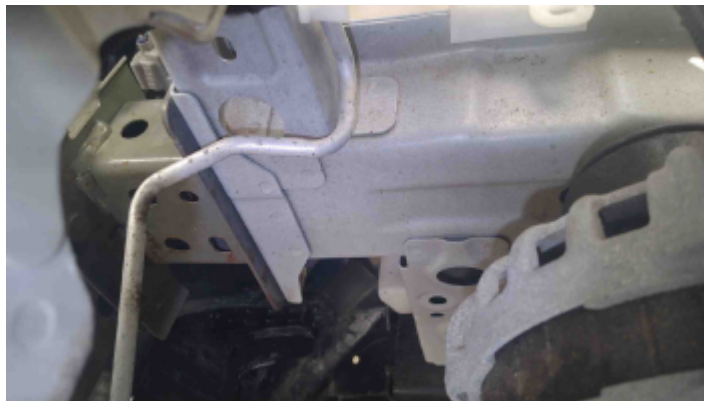
Foto Estrutura Longarina Direita
