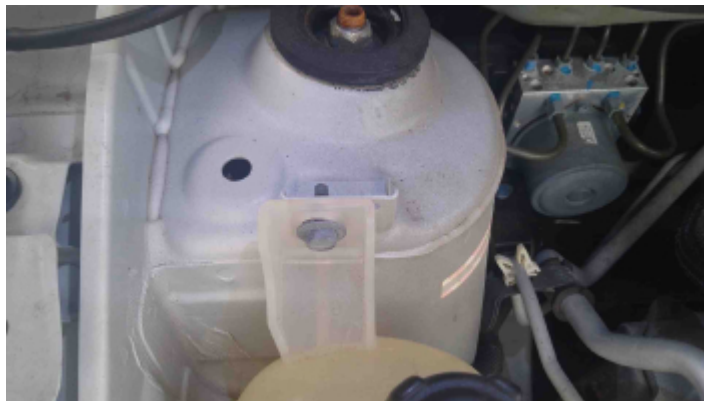
Foto Estrutura Torre do Amortecedor Direito
