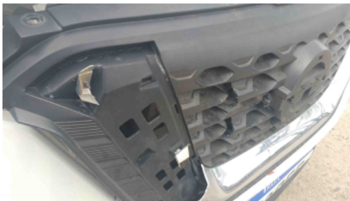
Foto Avaria Grade
