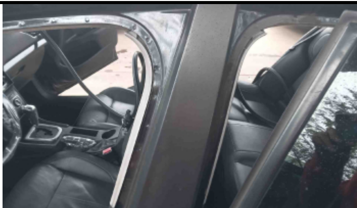
Foto Estrutura Coluna Central Esquerda
