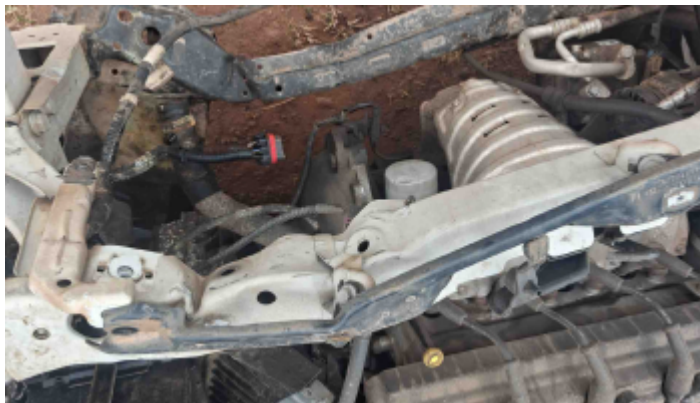
Foto Avaria Painel/Saia Dianteiro
