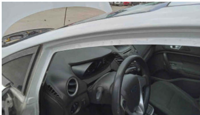
Foto Estrutura Coluna Dianteira Esquerda
