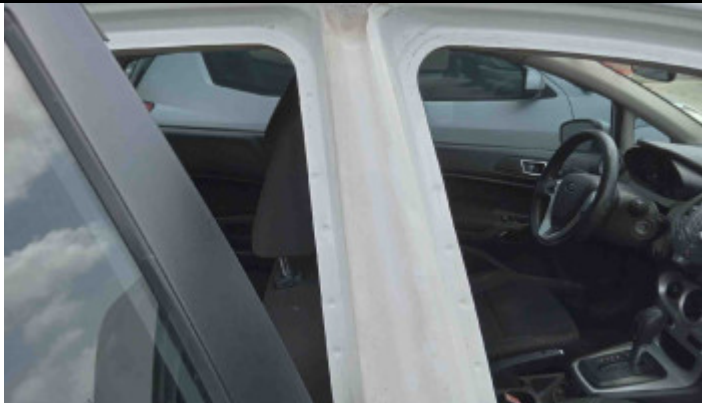
Foto Estrutura Coluna Central Direita
