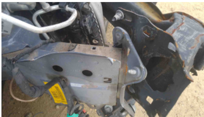
Foto Estrutura Longarina Direita
