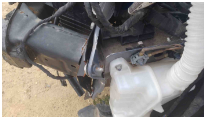
Foto Estrutura Longarina Esquerda
