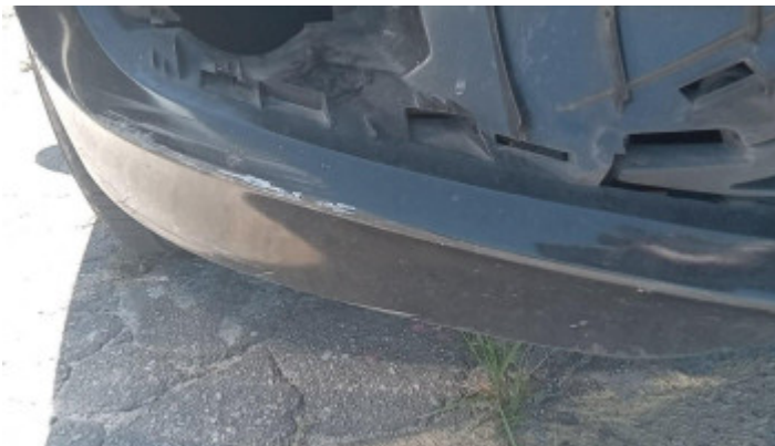
Avaria Painel/Saia Dianteiro
