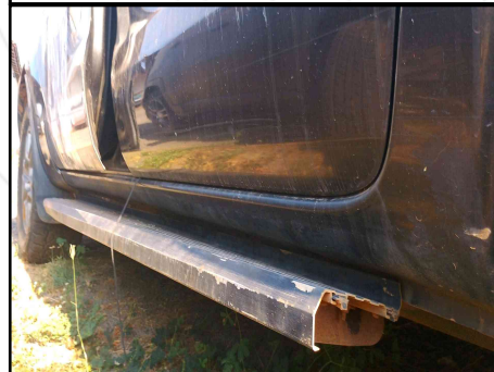
CAIXA DE AR/ SOLEIRA ESQUERDA
