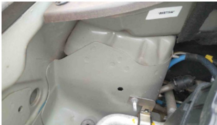
Foto Estrutura Torre do Amortecedor Direito
