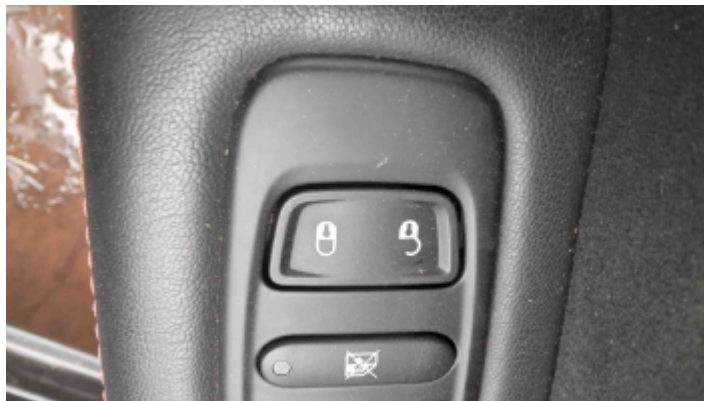
Foto Travas Elétricas
