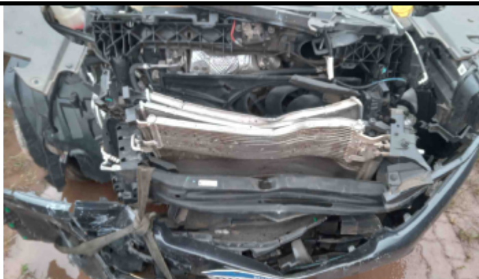
Foto Avaria Painel/Saia Dianteiro
