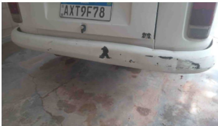
Foto Avaria Pára-Choque Traseiro
