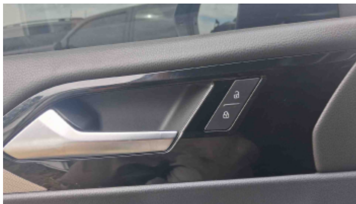
Foto Travas Elétricas
