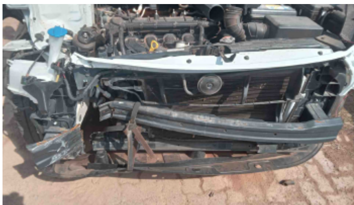
Foto Avaria Painel/Saia Dianteiro
