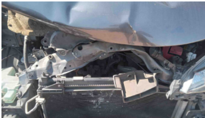
Foto Avaria Painel/Saia Dianteiro
