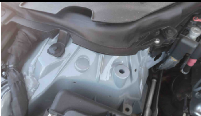
Foto Estrutura Torre do Amortecedor Direito
