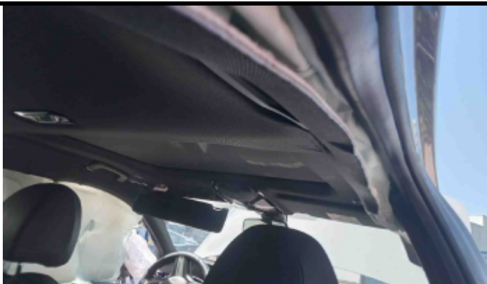
Foto Avaria Teto
