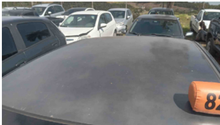
Foto Avaria Teto
