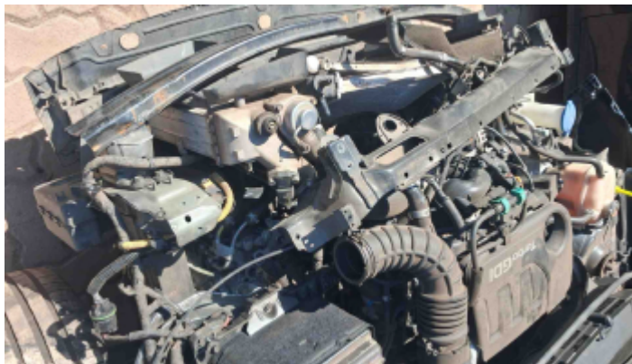
Foto Avaria Painel/Saia Dianteiro
