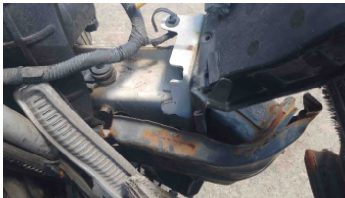
Foto Estrutura Longarina Esquerda
