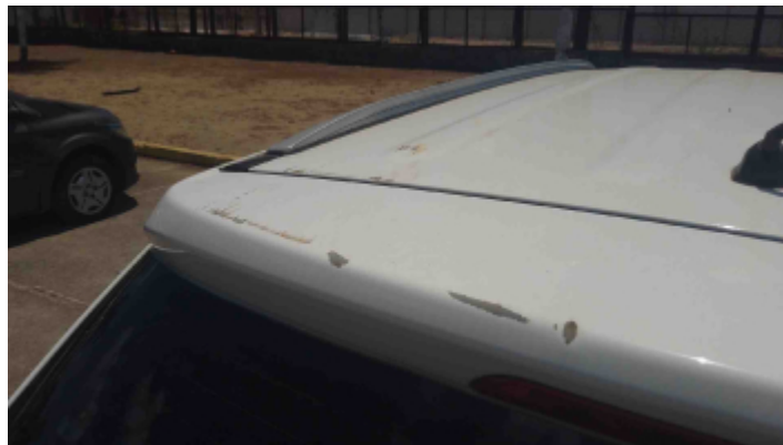
Foto Avaria Tampa do Porta Malas
