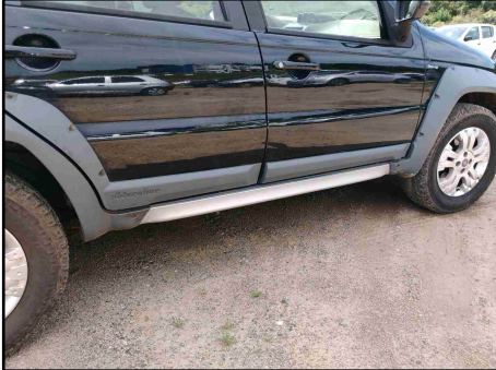
CAIXAS DE AR - SOLEIRA DIREITA
