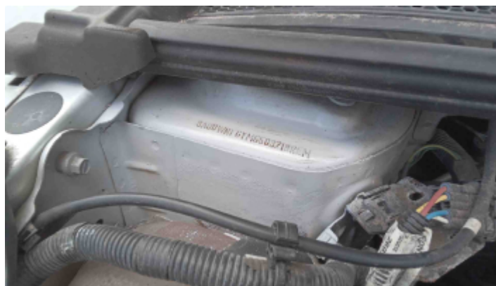
Foto Estrutura Torre do Amortecedor Direito
