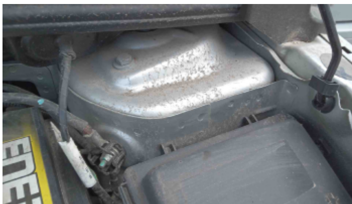
Foto Estrutura Torre do Amortecedor Esquerdo
