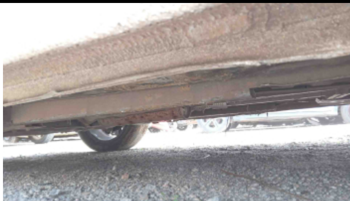
Foto Avaria Caixa de Ar (lado esquerdo)
