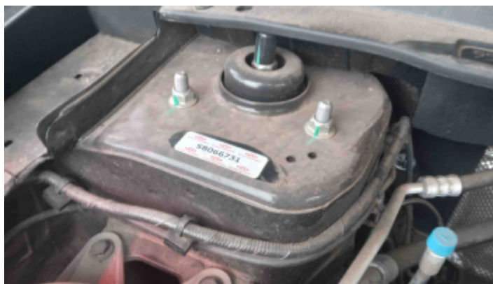
Foto Estrutura Torre do Amortecedor Direito
