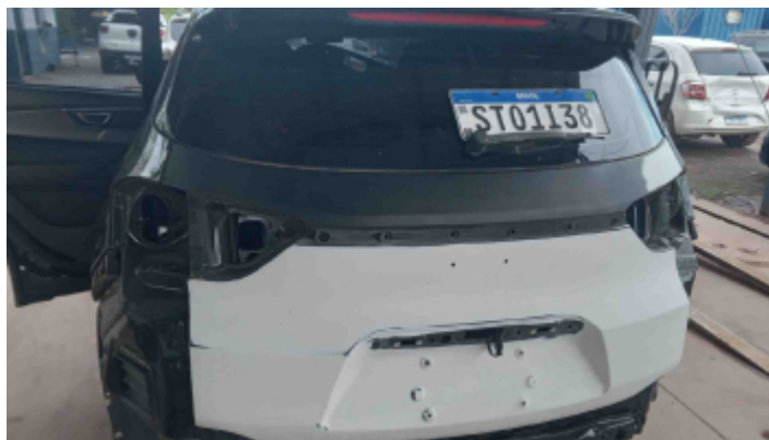
Foto Avaria Tampa do Porta Malas
