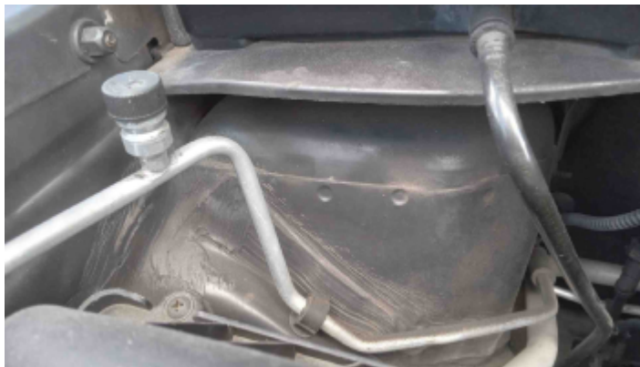
Foto Estrutura Torre do Amortecedor Direito
