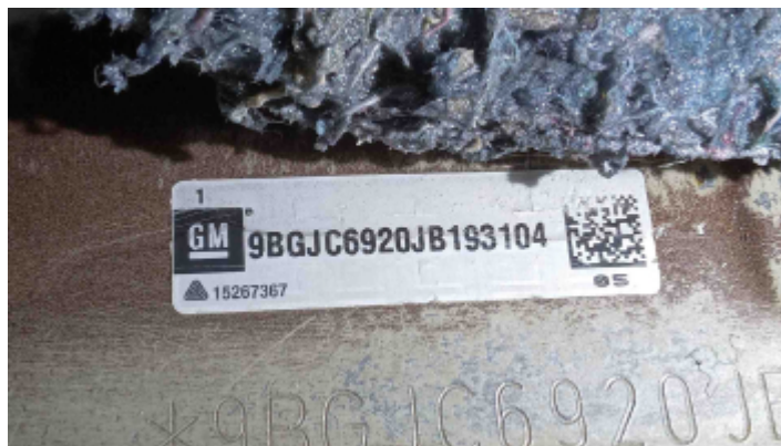
Foto da etiqueta ETA (assoalho)
