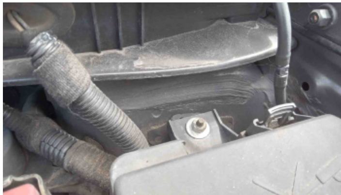
Foto Estrutura Torre do Amortecedor Esquerdo
