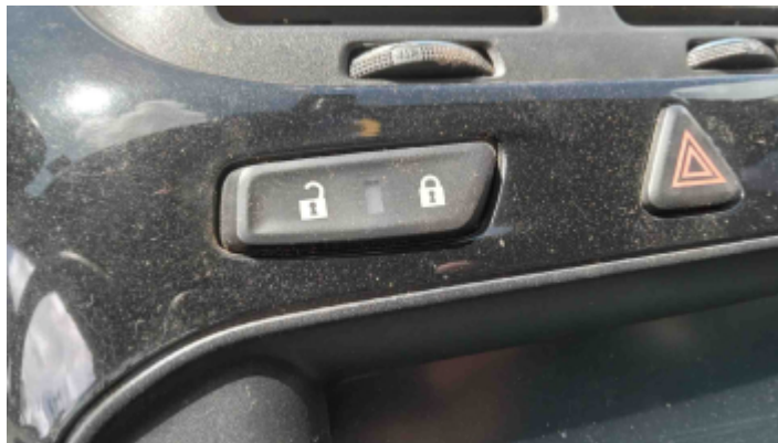
Foto Travas Elétricas
