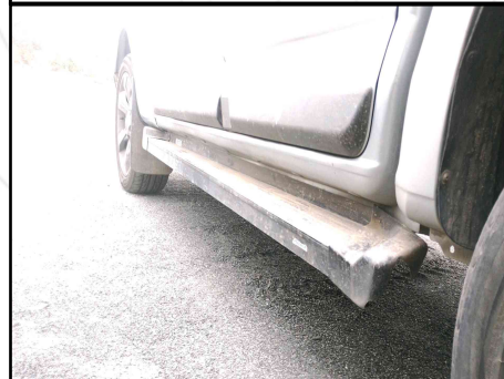
CAIXA DE AR/ SOLEIRA ESQUERDA
