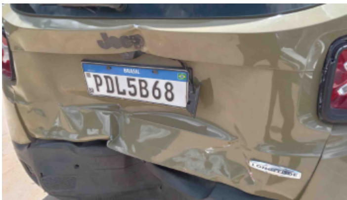
Foto Avaria Tampa do Porta Malas
