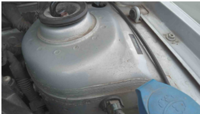
Foto Estrutura Torre do Amortecedor Esquerdo
