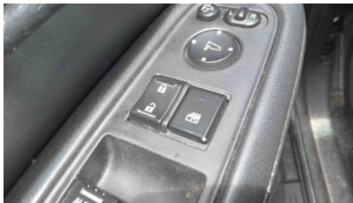
Foto Travas Elétricas
