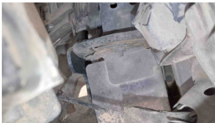
Foto Estrutura Longarina Esquerda
