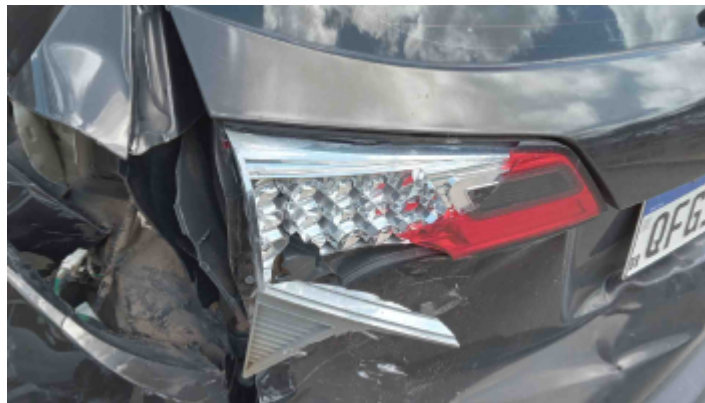
Foto Avaria Lanterna Esquerda
