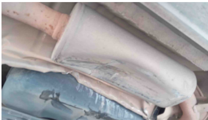
Foto Avaria Escapamento
