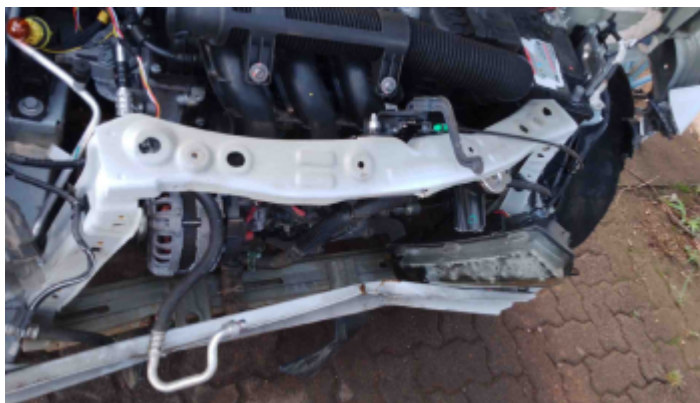
Foto Avaria Painel/Saia Dianteiro
