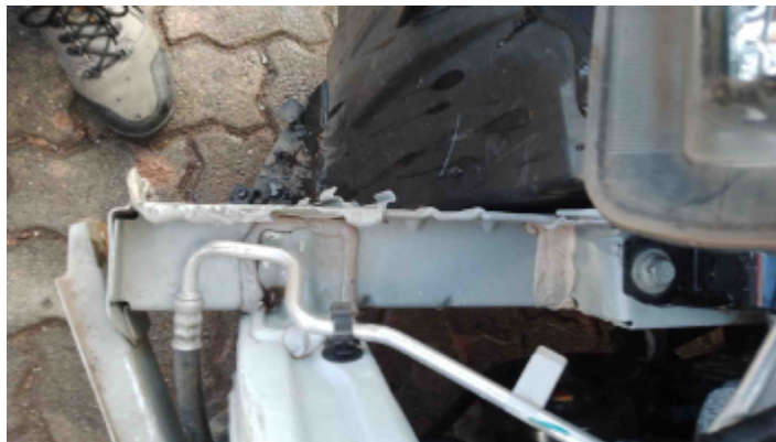
Foto Estrutura Longarina Direita
