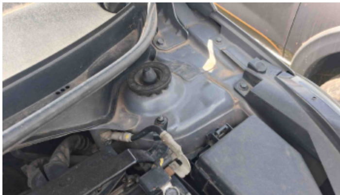
Foto Estrutura Torre do Amortecedor Esquerdo
