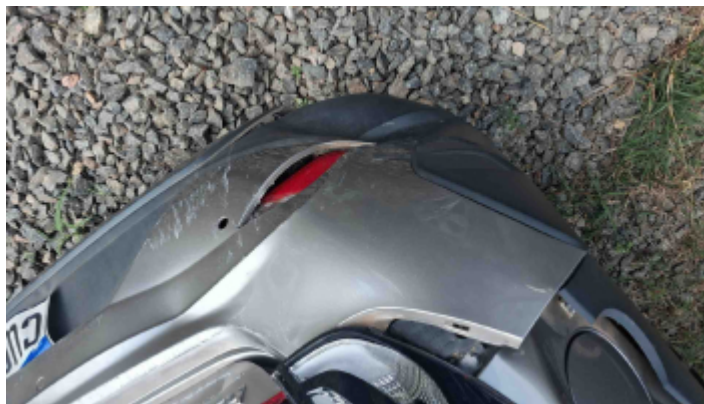
Foto Avaria Pára-Choque Traseiro
