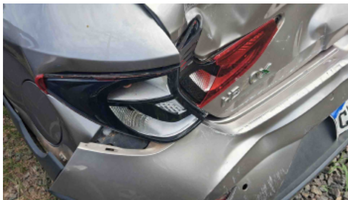
Foto Avaria Lanterna Esquerda
