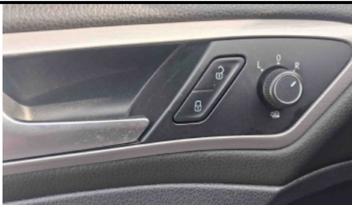
Foto Travas Elétricas
