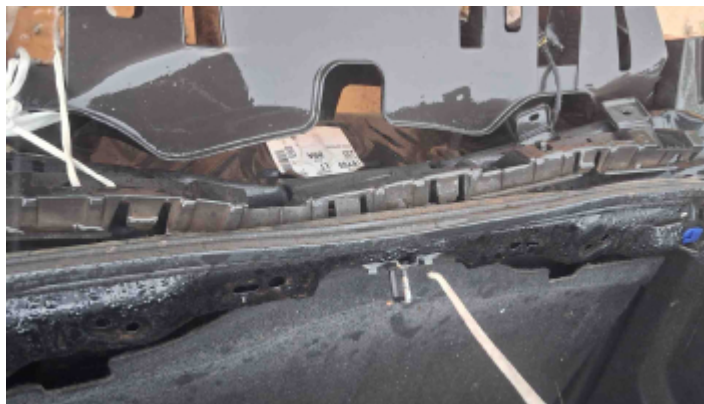
Foto Avaria Painel/Saia Traseiro
