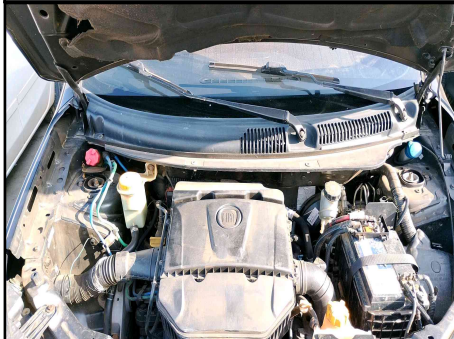
PAINEL CORTA FOGO
