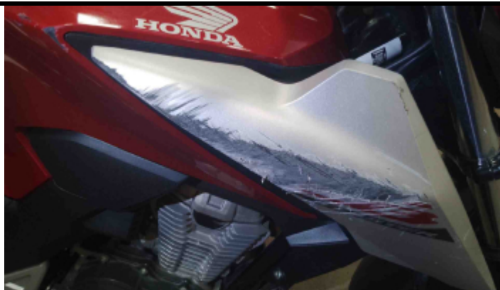
Foto Avaria Carenagem Direita
