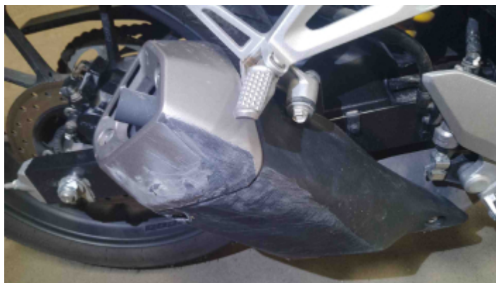
Foto Avaria Escapamento
