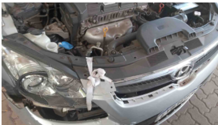
Foto Avaria Painel/Saia Dianteiro
