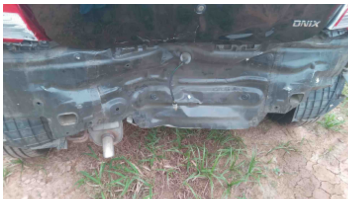
Foto Avaria Painel/Saia Traseiro
