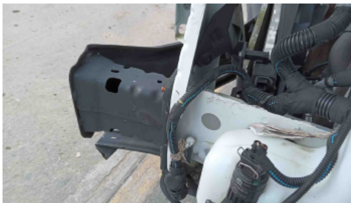
Foto Estrutura Longarina Esquerda
