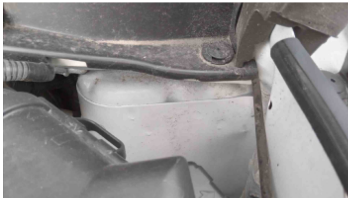
Foto Estrutura Torre do Amortecedor Esquerdo
