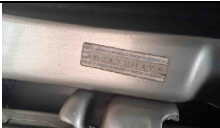
Foto da etiqueta ETA (batente da porta)
