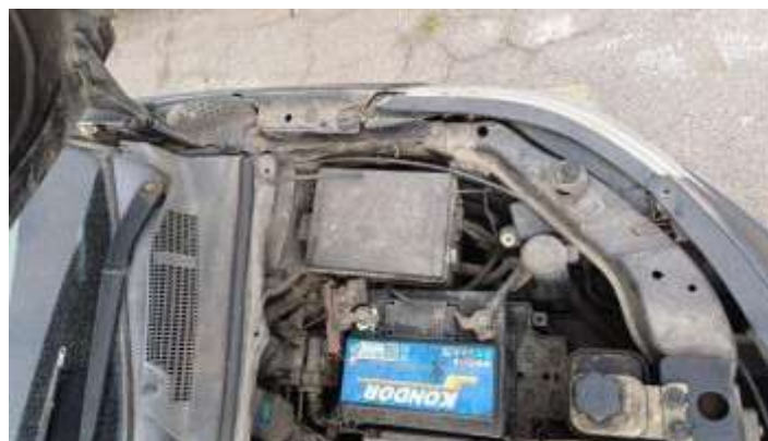
Estrutura Torre do Amortecedor Esquerdo
