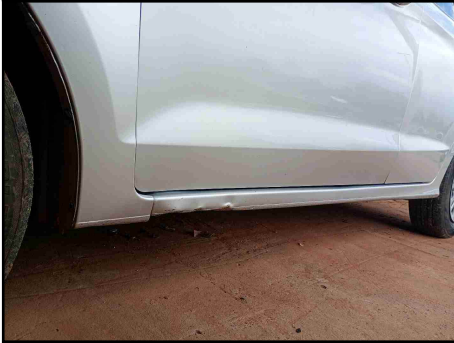
CAIXA DE AR/ SOLEIRA ESQUERDA
