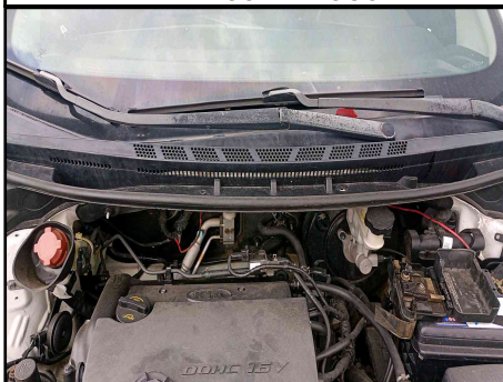
PAINEL CORTA FOGO
