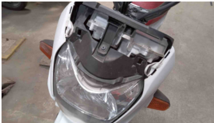
Foto Avaria Carenagem Frontal
