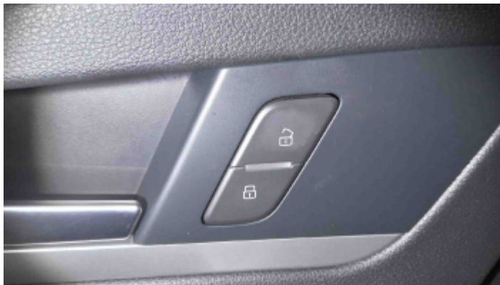
Foto Travas Elétricas
