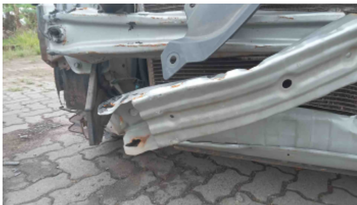
Foto Avaria Painel Dianteiro
