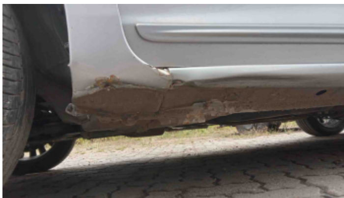
Foto Avaria Caixa de Ar (lado esquerdo)
