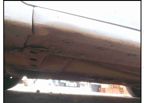
CAIXAS DE AR - SOLEIRA ESQUERDA
